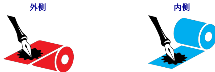
图 7 • 涂层在内侧或外侧的色带
